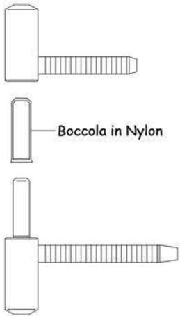
Cerniere anuba in acciaio con boccola in nylon anticigolamento e perno antisbandieramento
